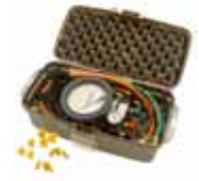
Equipo para prueba de contraflujo
